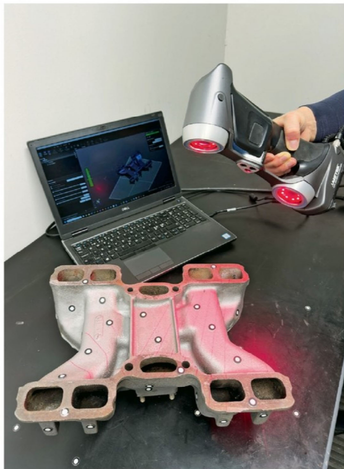
Kuvassa 3D-skannauksen avulla hankalat geometriat voidaan taltioida ja verrata olemassa olevaan CAD-malliin tai luoda täysin uusi CAD-malli, mitatun geometrian perusteella.
